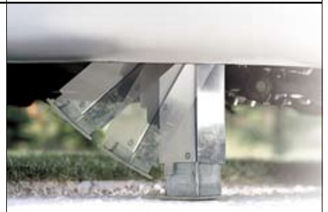
Da das Fahrzeug vollkommen angehoben werden kann, sind alle Reifen vor Standschäden geschützt.
