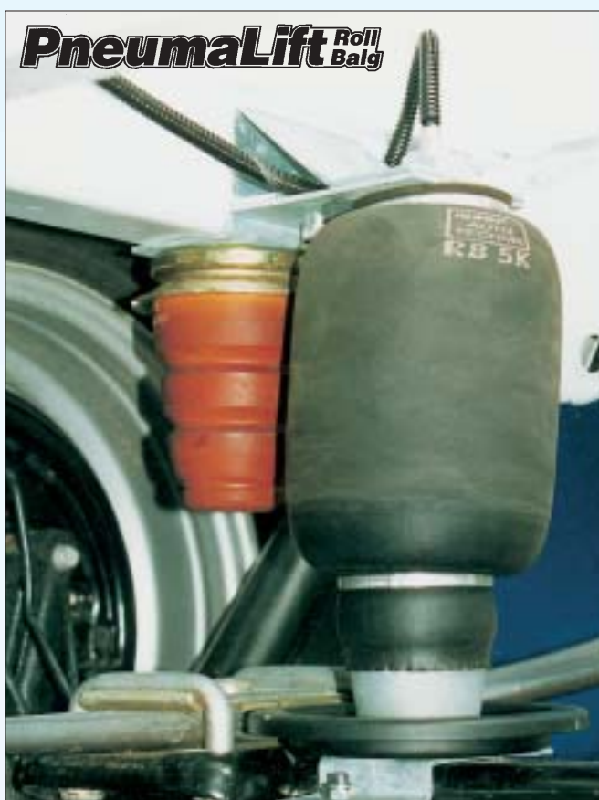
Der 5-Zoll-Rollball als Zusatzluftfeder für weniger stark belastete Euro-Chassis. Wegen der hohen Luftfederbauhöhe kann dieser Balg in der Regel nicht in idealer Position montiert werden.
