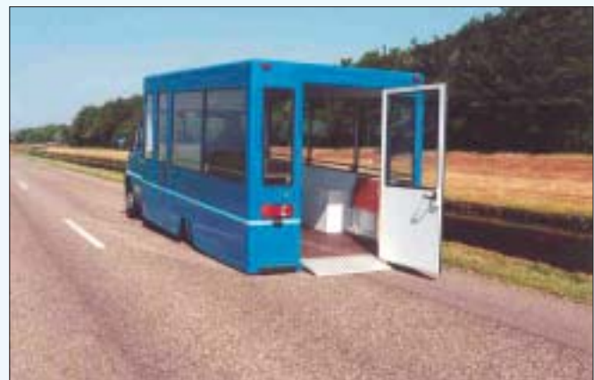
Ein Fahrzeug mit Voll-Luftfederung an der Hinterachse in abgesenktem Zustand
